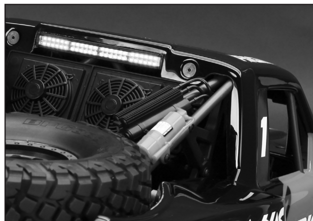
Zamontowana tylna listwa świetlna LED
