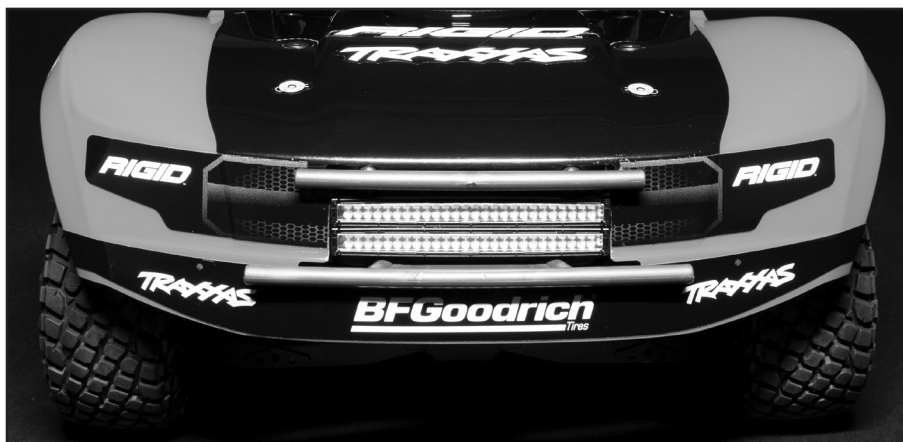
Zainstalowano listwę świetlną LED grilla
