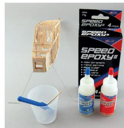
Do przyklejenia drucianego podwozia do Krogulca użyto Speed Epoxy.
