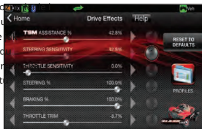
Dotknij i przesuń, aby dostosować TSM, czułość układu kierowniczego, Trym przepustnicy, procent hamowania i wiele więcej!
